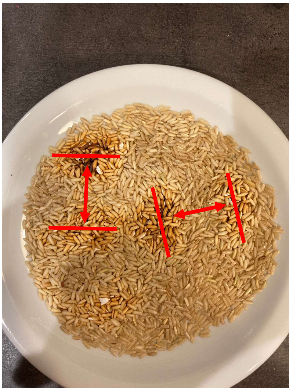
Fot. 4 Ryżowa "mapa" promieniowania z zaznaczonymi odległościami które można zmierzyć (trzeba zmierzyć tylko jedną!)
